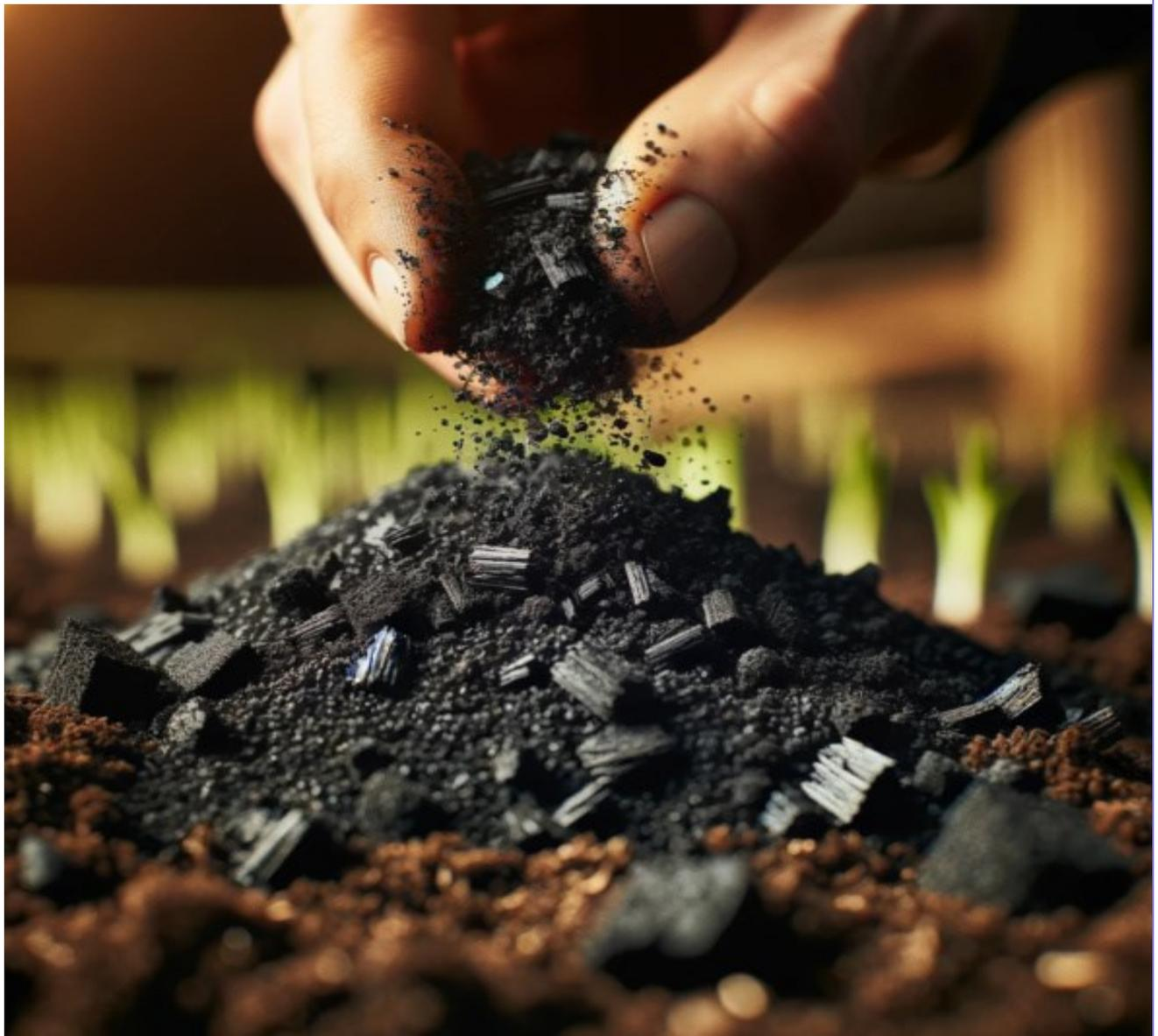
Por meio do processo termoquímico de pirólise, a biomassa da cana-de-açúcar sofre decomposição térmica em temperaturas superiores a 300 °C em um ambiente livre de oxigênio.
